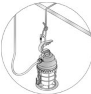
Içamento com corda pelo mosquetão
