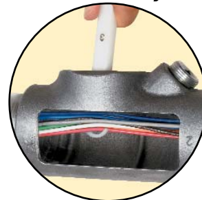
Gancho, ferramenta #3 eleve facilmente todos os condutores.
